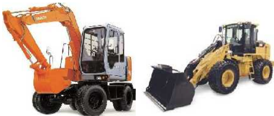
Figure VII.02: La pelle hydraulique et le chargeur.
