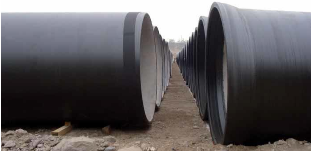
Figure III.2 : Photo des conduites en fonte ductile de PAM Saint-Gobain.
