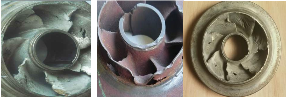
Figure VI.9 : Roues soumises à la cavitation
