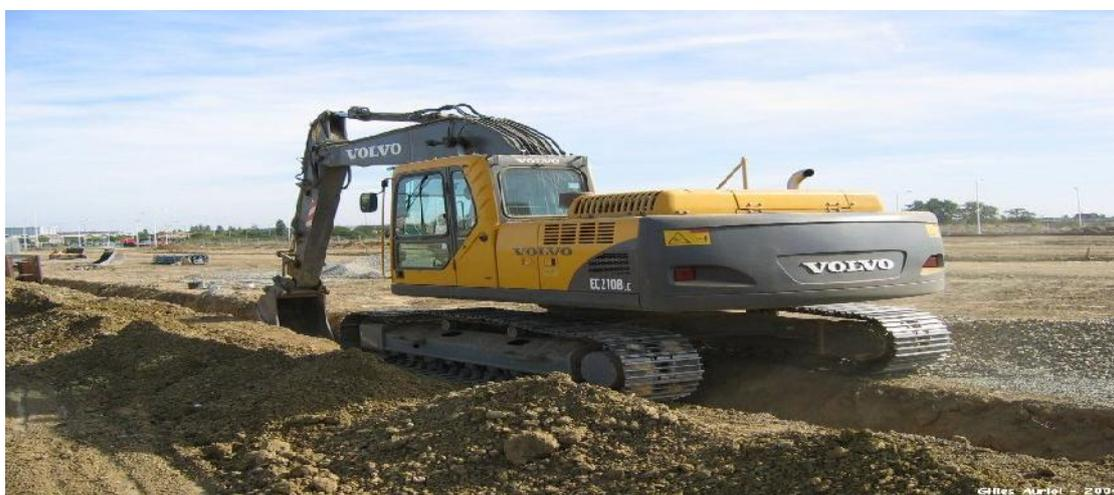
**Figure VI.1 :** Pelle hydraulique
