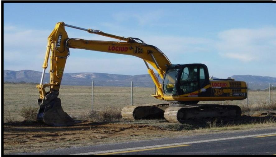
**Figure IX.1: Pelle équipée en rétro**
