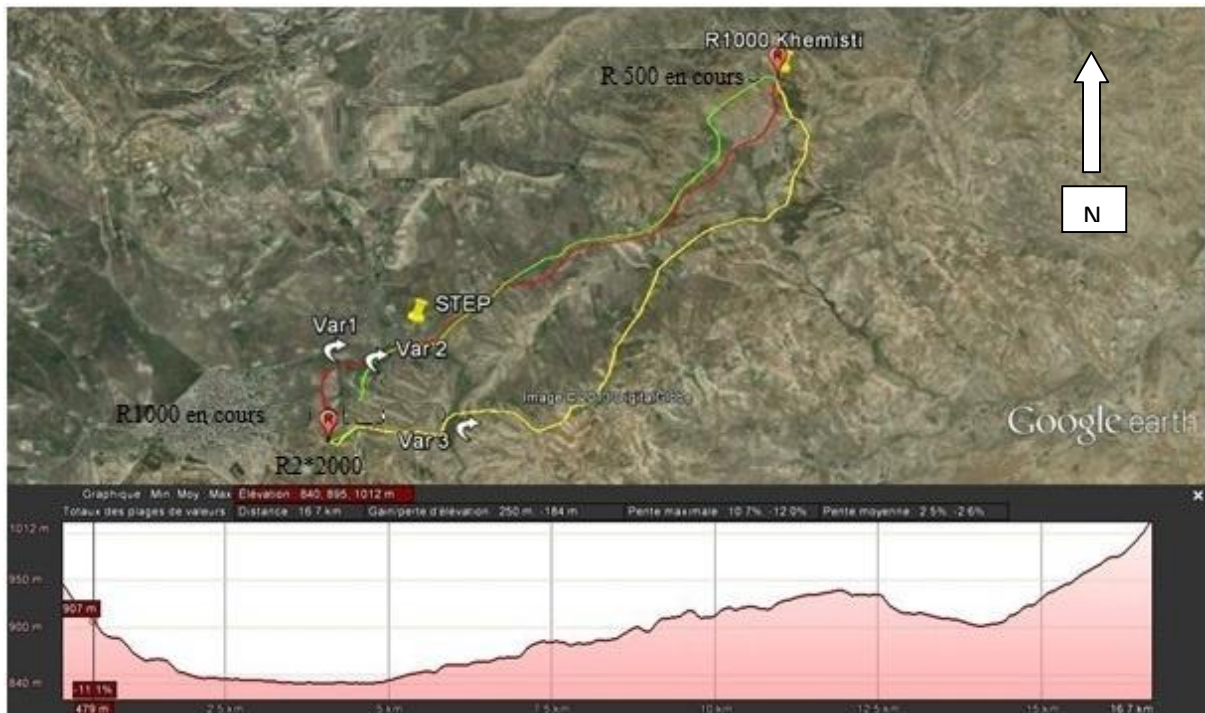
Figure IV 1: vue en plan et profil variante 1
