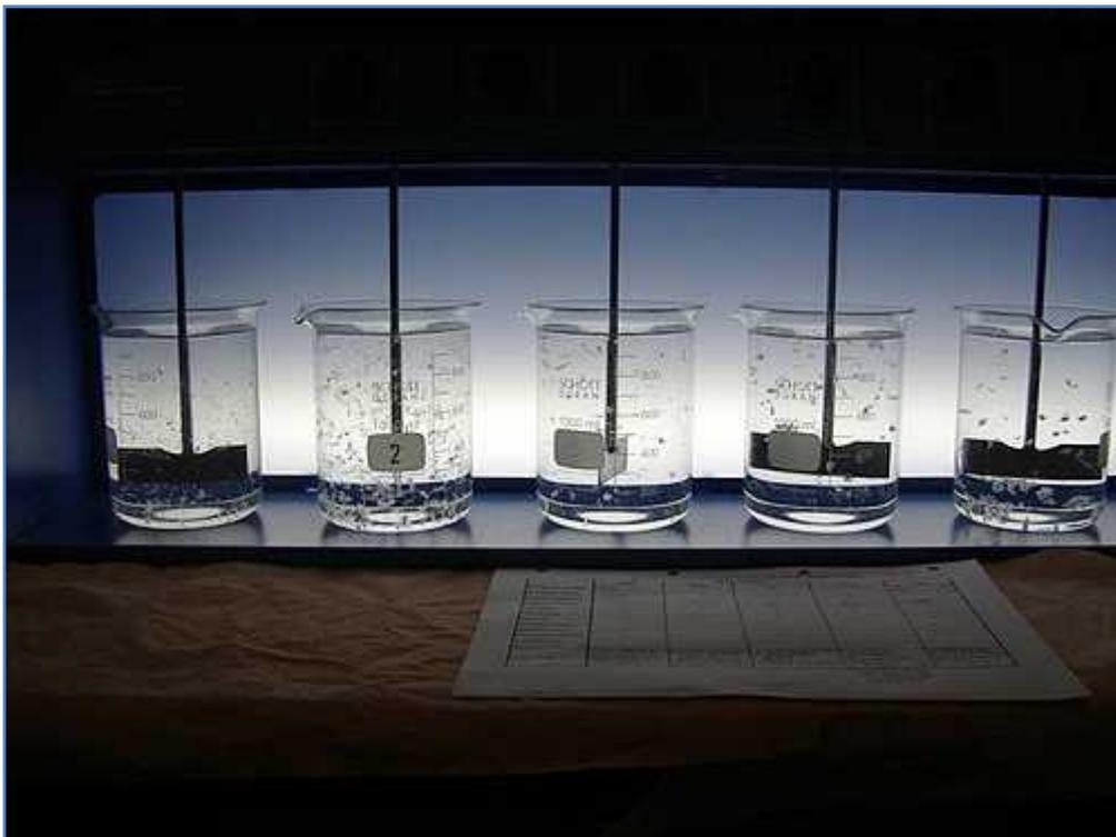
**Figure III.2 :** Essai de jar-test
