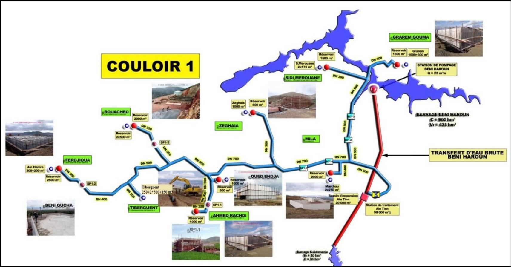
Figure I.4 : Transfert couloir 01 à partir du barrage Beni Haroun (BBH).
