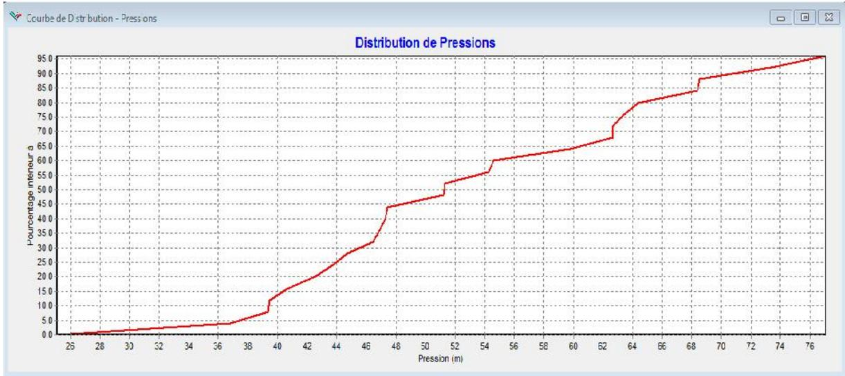
**Figure I.1 :** distribution de pression dans les conduites du réseau projeté de Tiberguent (variante1).
