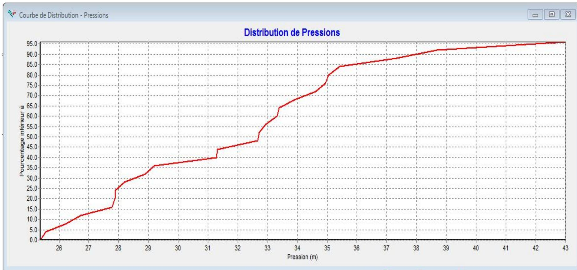
Figure IV.5 : distribution de pression dans les conduites du réseau projeté de Tiberguent
