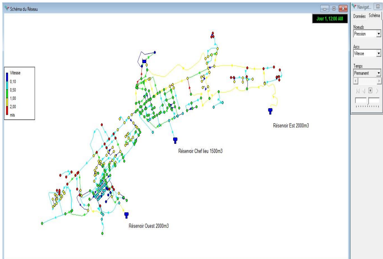
Figure 2: Simulation affichant les pressions au sol et les vitesses d'écoulements en cas de pointe plus incendie
