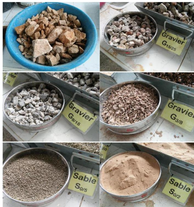
Figure III. 1 Les granulats utilisés
