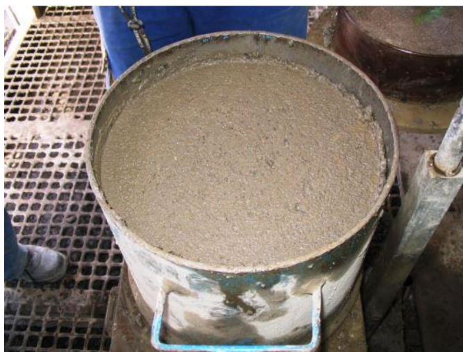
Figure I. 2 Mesure de la masse volumique du BCR.
