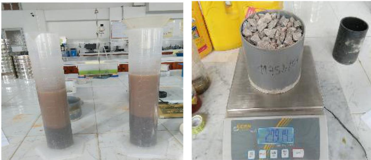
Figure III. 4 Essais de mesure des masses volumiques : (a) absolue ; (b) apparente
