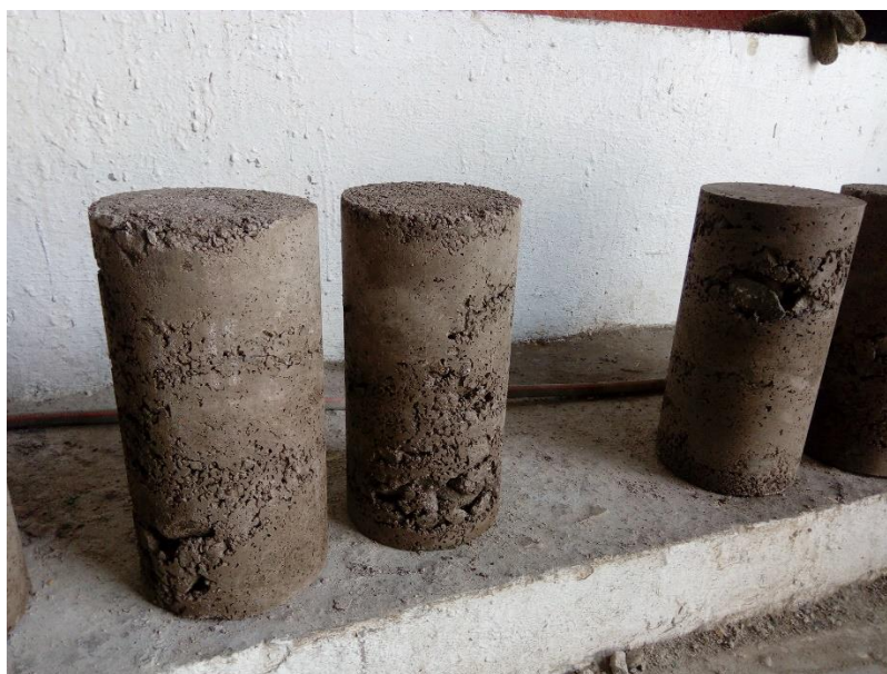
Figure I. 3 Phénomène de ségrégation sur un mélange BCR réalisé au laboratoire
