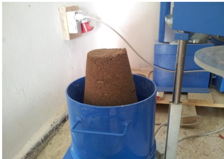
Figure I. 1 Détermination de la maniabilité à l'aide du test VeBe
