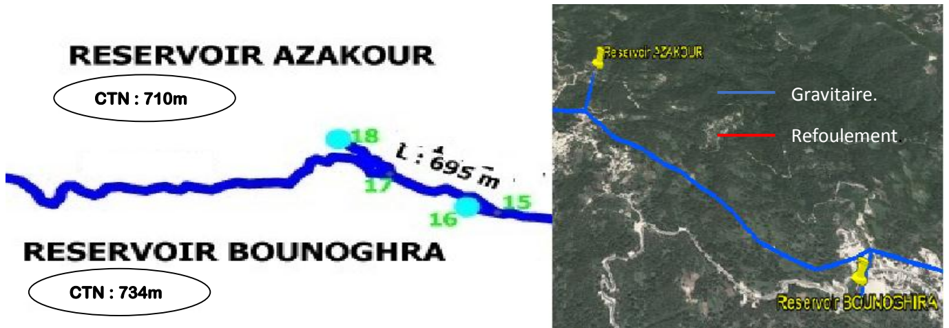
Figure III.4.h: Le tracé en plan de la variante I (RESERVOIR BOUNOGHRA vers PIQUAGE AZAKOUR & EL OULDJA)
