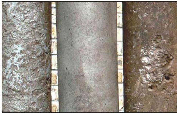
Figure VI.3 : Echantillons de conduite en fonte ductile, celle du milieu possède un revêtement en polyéthylène contrairement aux deux autres. (Source AWWA)
