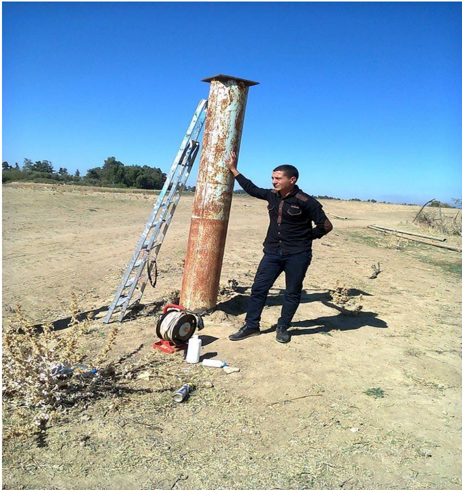
Figure 35 : Piézomètre dans la nappe du Haut et du Moyen Chélif.
