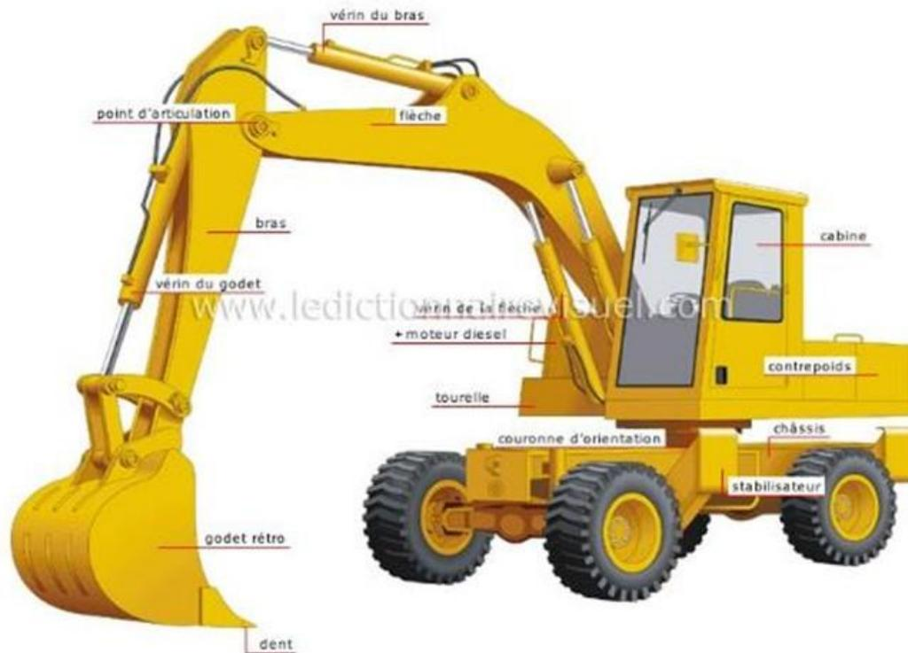
**Figure 4** Pelle hydraulique
