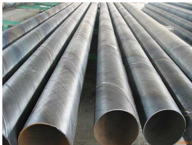
Figure V.8 : Conduite en acier
