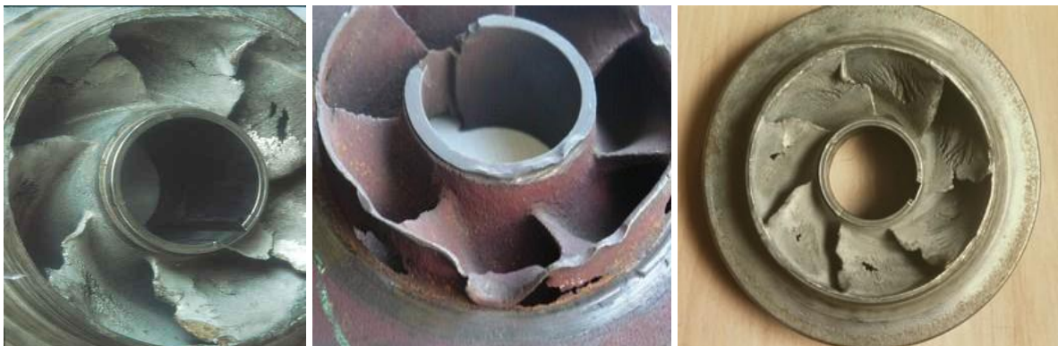
Figure VI.6 : Roues soumises à la cavitation.
