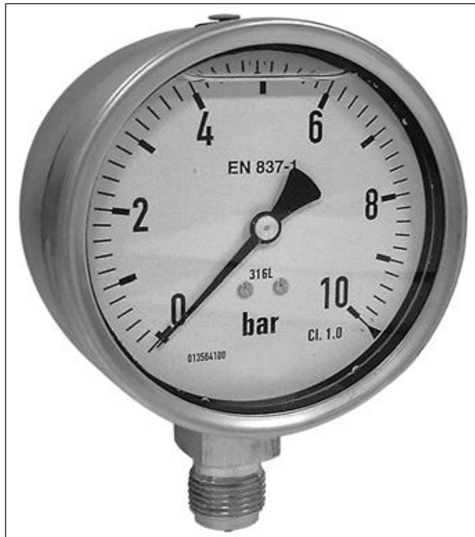
Figure 5.4: Manomètre (d'après document BAMO)
