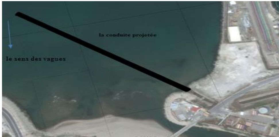
Figure VI.04 : l'emplacement de la conduite (vue en haut) [17]
