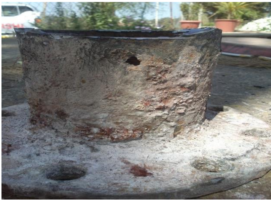
Figure II.1 : Etat des conduites en FTI (SEAAL.2013)
