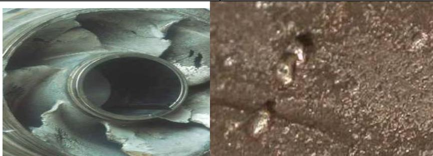
**Figure V.17** : Photo illustre le phénomène de cavitation sur des aubes de pompe centrifuge et les piqûres de cavitation
