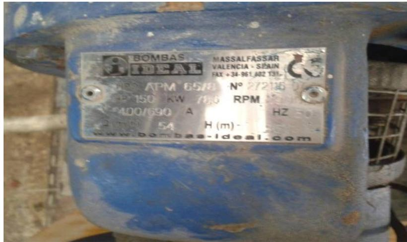
Figure V.10 : Plaque analytique de la pompe de TALLAIZID
