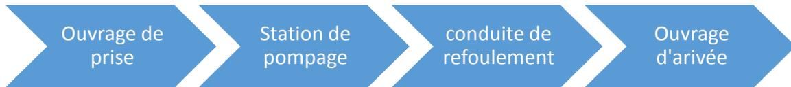
**Figure 13- Schéma de station en rivière ou en retenue**
