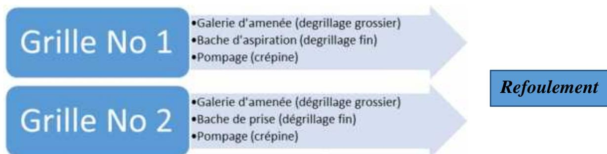
Figure 15- Schéma du système de prise, vue de plan
