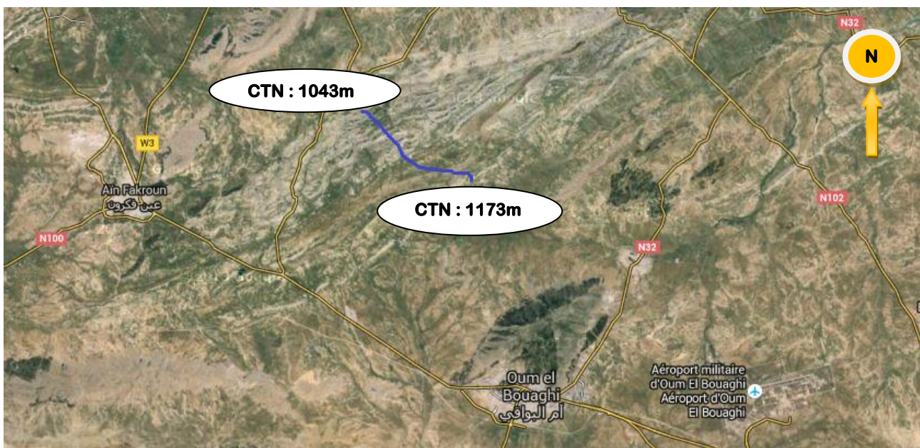
Figure III.2: Le tracé en plan de la variante I (Forage B1 vers Réservoir AD2).
