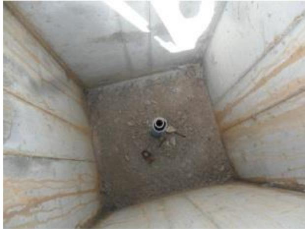
**Figure III.9 : Tube tassométrique**
