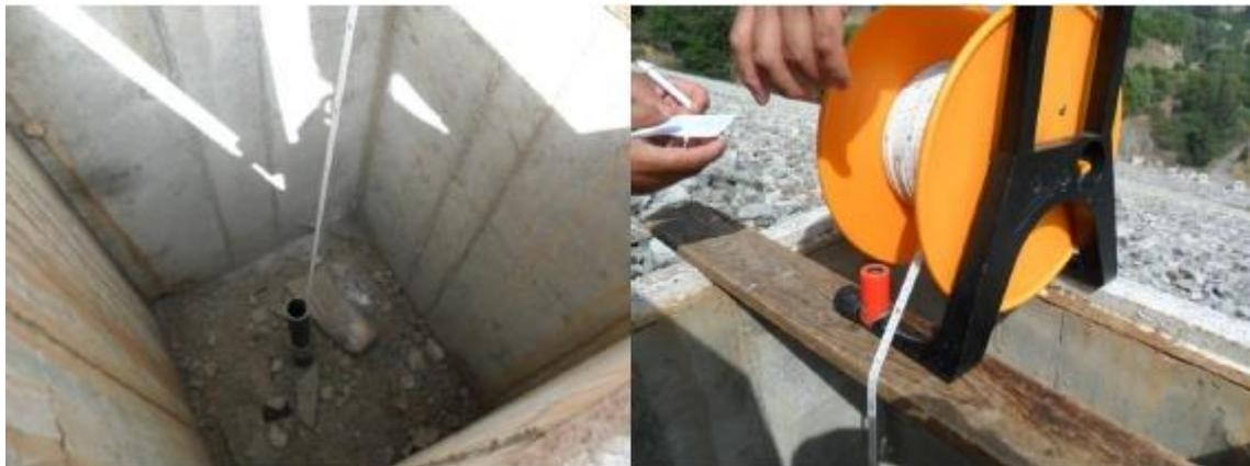
Figure III.1: Mesure piézométrique
