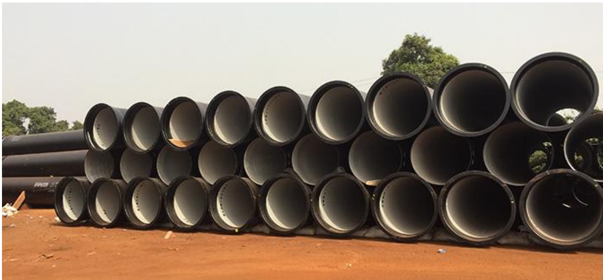
Figure IV.1. Conduite en fonte
