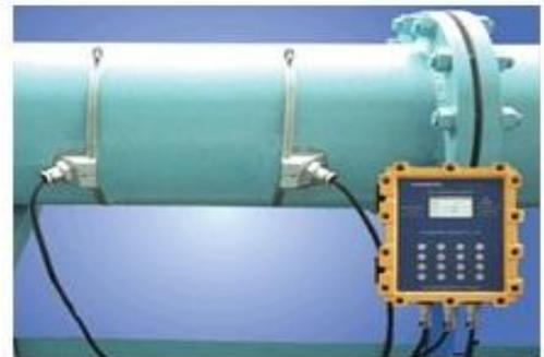
**Figure 39 : débitmètre à ultrason**
