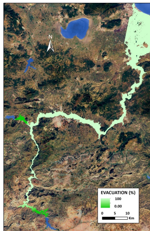
Figure IV .47: Taux de la population évacuée en cas de rupture simultanée du barrage Hammam Debagh et du barrage Foug El Khanga.
