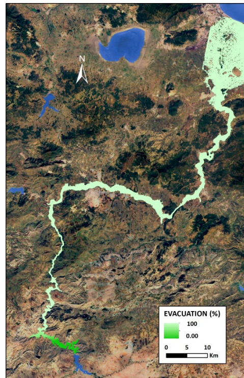
Figure IV .46: Taux de la population évacuée en cas de rupture du barrage Foug El Khanga.
