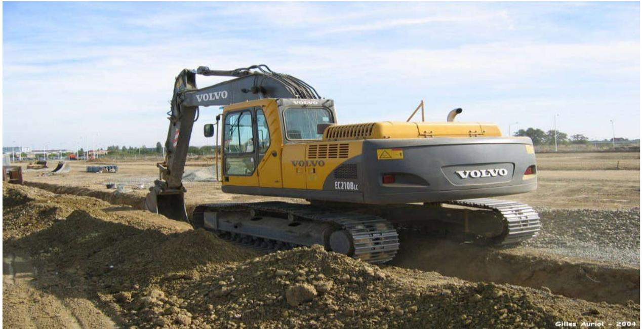
**Figure VIII.1:** Pelle hydraulique.
