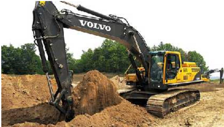
**Figure VIII.2 : Pelle hydraulique**
