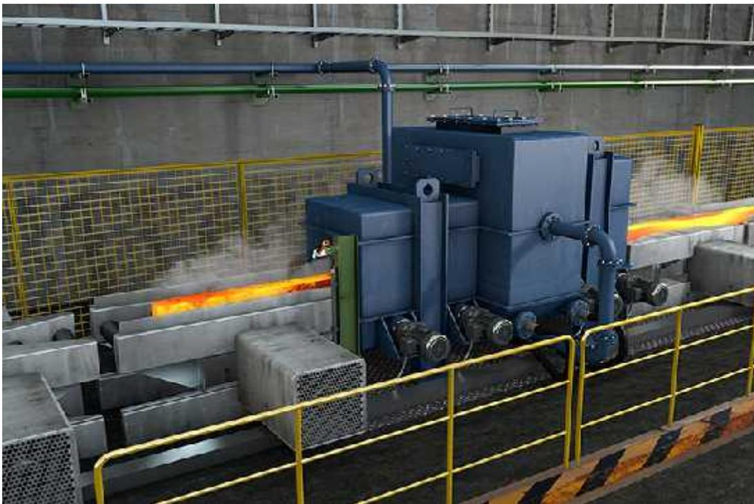
**Figure II.4** Décalaminage d'acier dans l'usine de laminage à chaud
