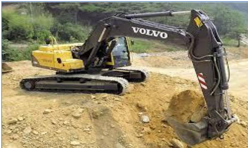
**Figure VII. 2** : Pelle équipée en rétro
