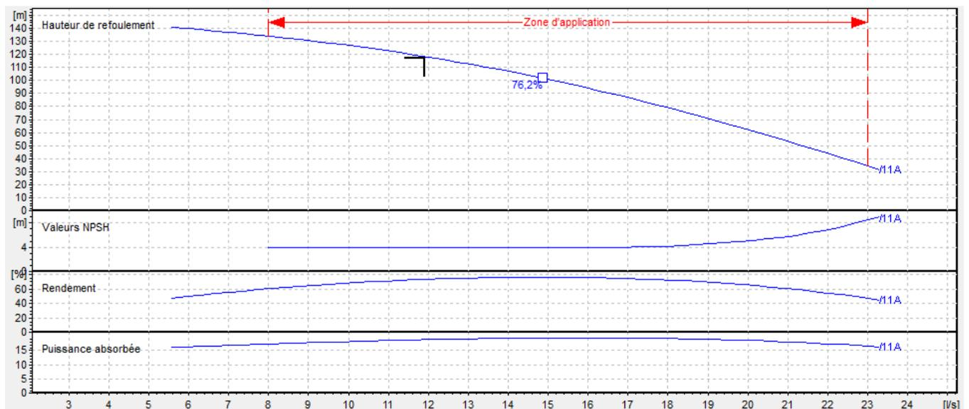
Figure V. 5 : Courbes caractéristiques de la pompe pour le forage M12.
