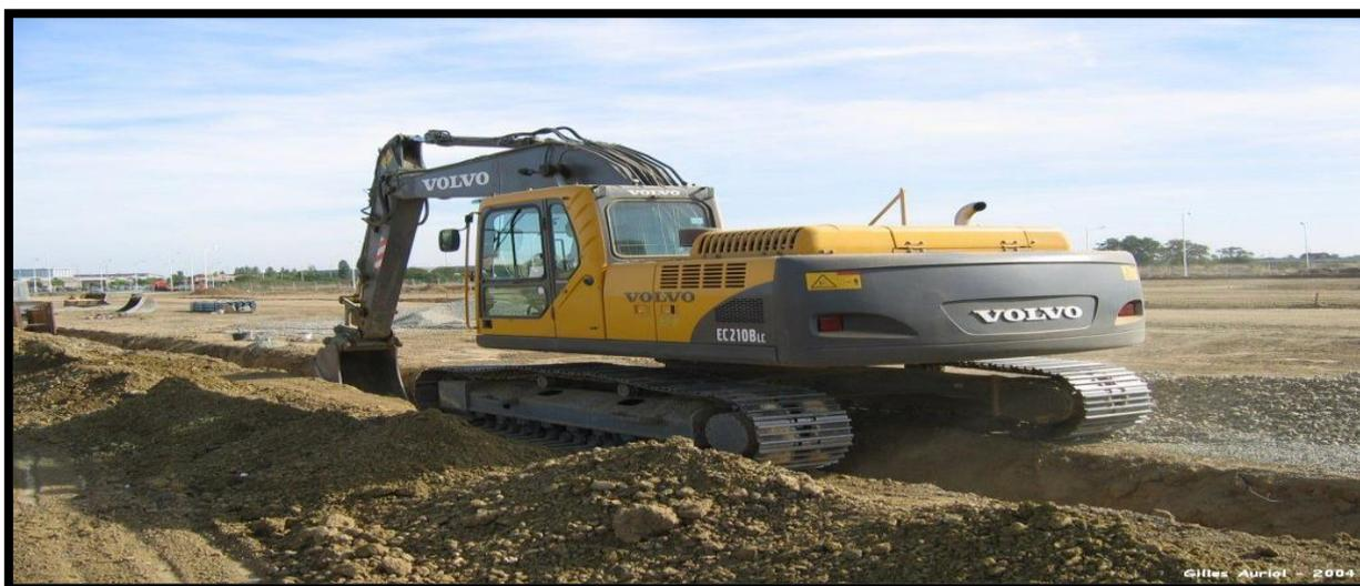
Figure VI.1 : Pelle hydraulique
