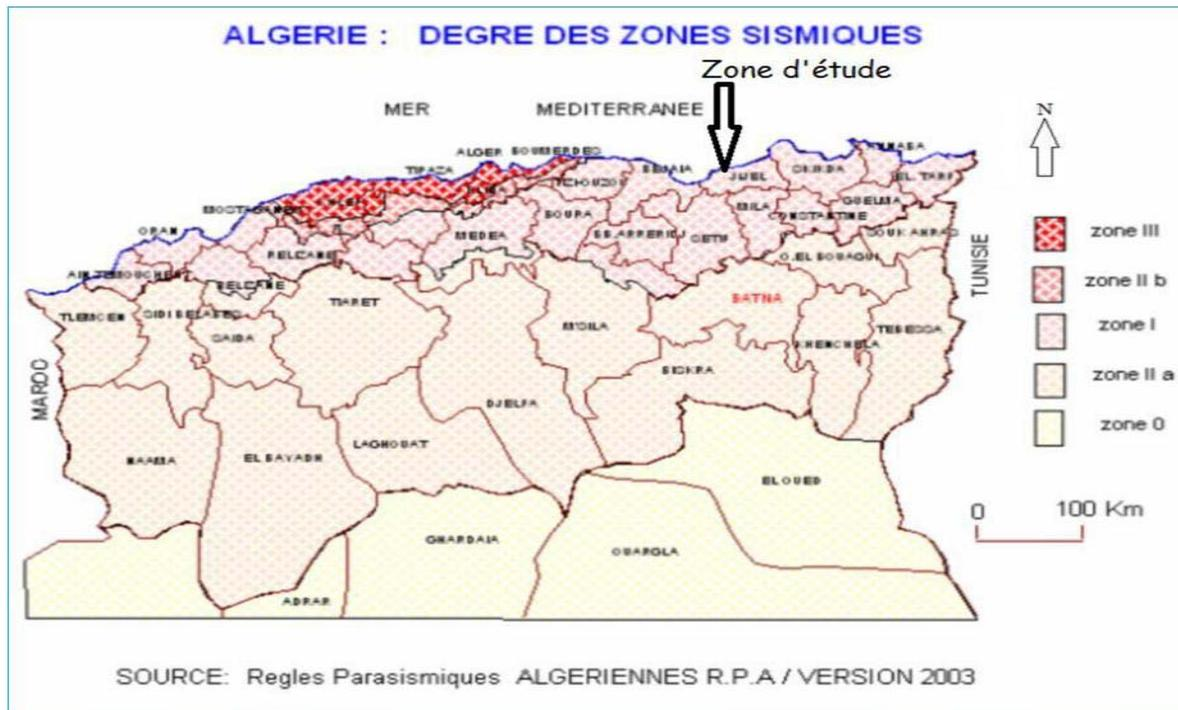
Figure I.3 : Carte des zones sismiques de l'Algérie et le zonage global des différentes Wilayas.
