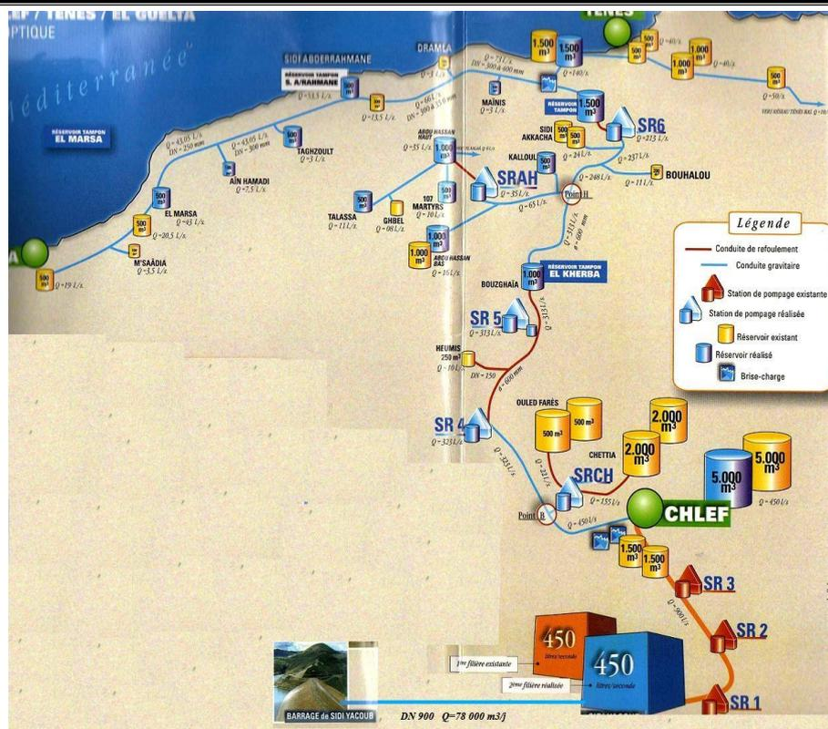
Figure I-4 : Schéma synoptique de l'ancienne alimentation à partir du barrage de Sidi Yacoub.
