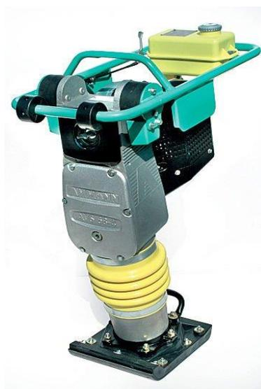
Figure. VI.5 : compacteur manuel (pilonneuse)
