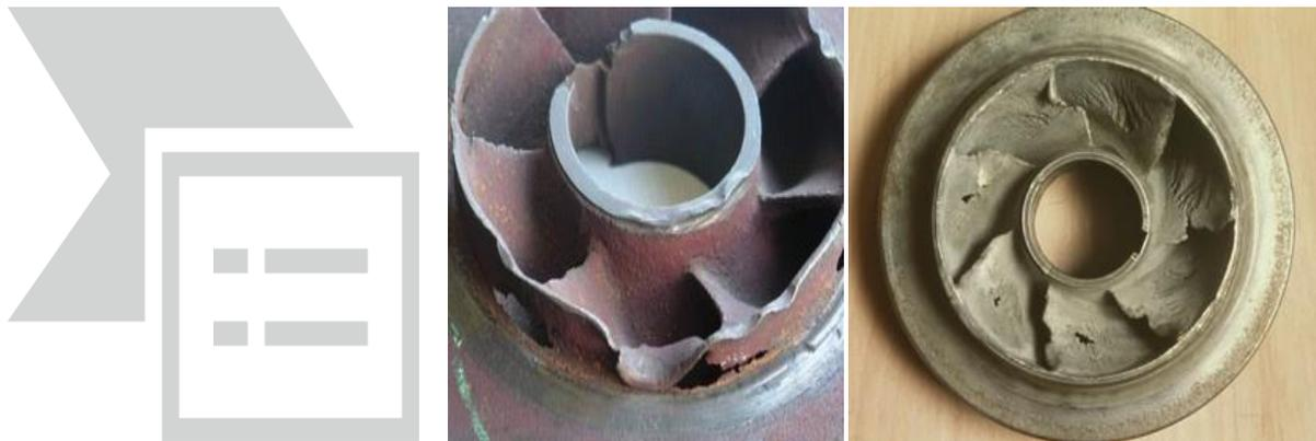
Figure IV.2 : Roues soumises à la cavitation.
