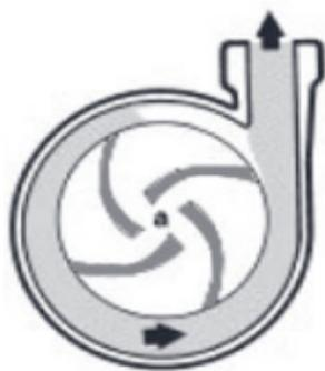
Le rôle d'une pompe consiste en effet à conférer de l'énergie au liquide pompé (énergie transformée ensuite en débit et en hauteur d'élévation) selon les caractéristiques de fabrication de la pompe elle-même et en fonction des besoins spécifiques à l'installation. Le fonctionnement est simple : ces pompes utilisent l'effet centrifuge
