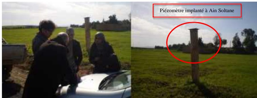
Figure 29: Piézomètre dans la nappe du Haut Cheliff.
