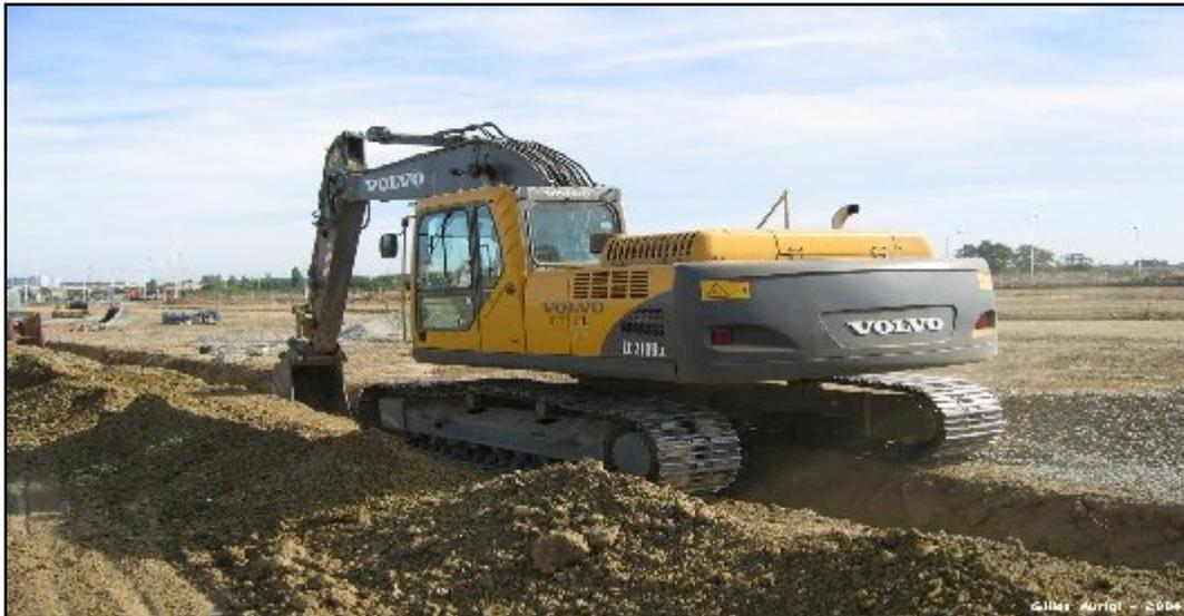
**Figure VI.1 :** Pelle hydraulique
