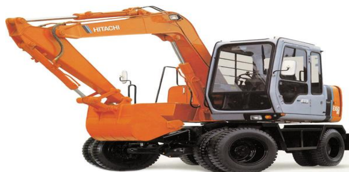
Figure VII. 2 : une pelle mécanique
