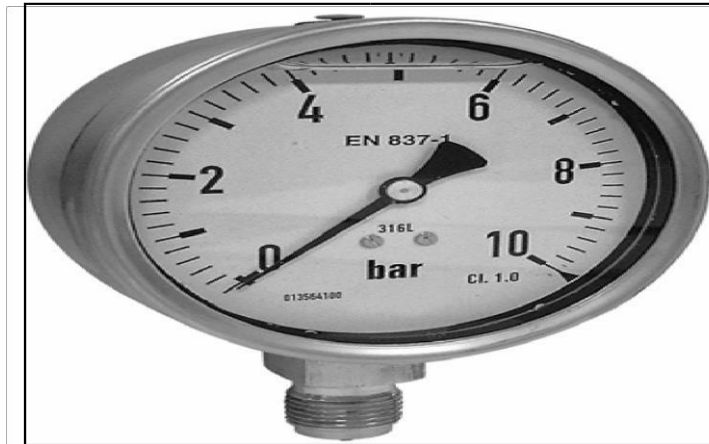
Figure V.6 : Manomètre (d'après document BAMO)
