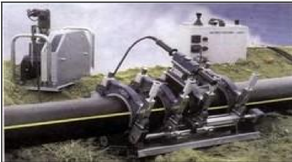
Figure 7.6 : Bout à bout « bouteille »
