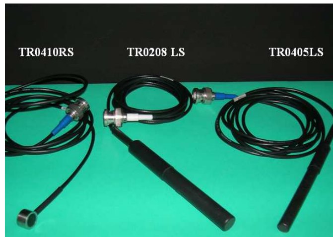
Figure 3.20 : Différentes sondes employées lors des essais de mesures des vitesses en milieu poreux
