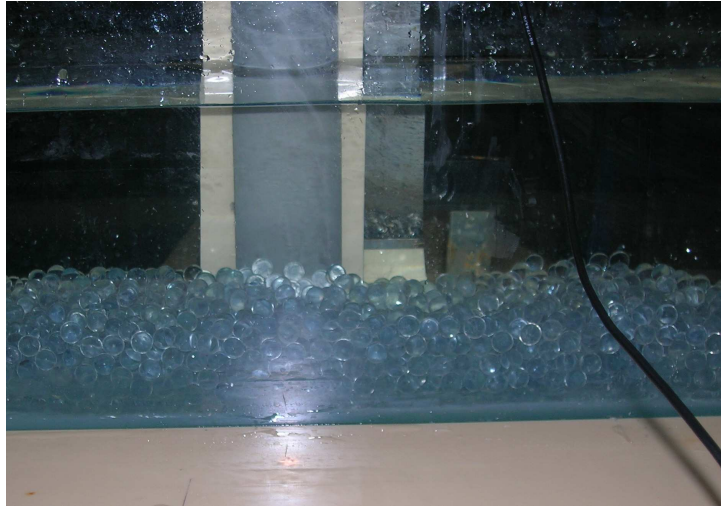
Figure 4.16: Mesure des vitesses d'écoulement sur un lit sédimentaire en billes de verre D= 3,80-4,40 mm
