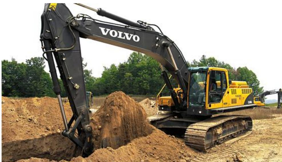
Figure VIII-2 : Pelle hydraulique
