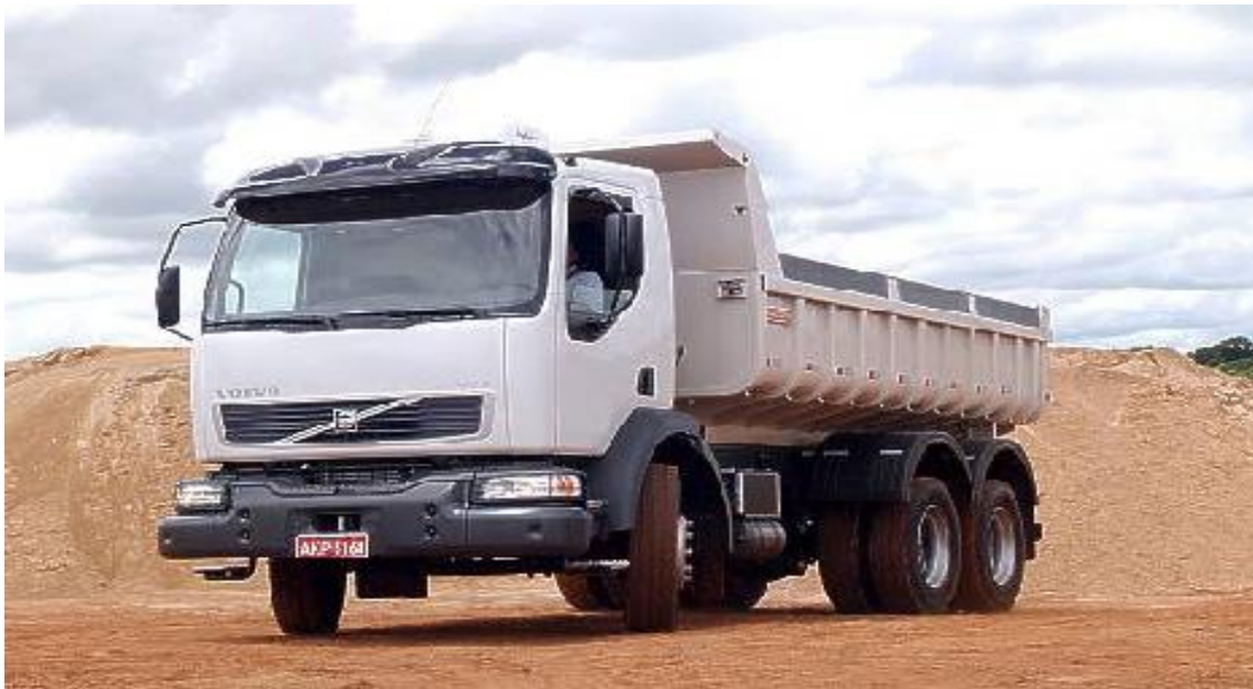
Figure VIII- 5 Camion de transport des terres de 8 tonnes
