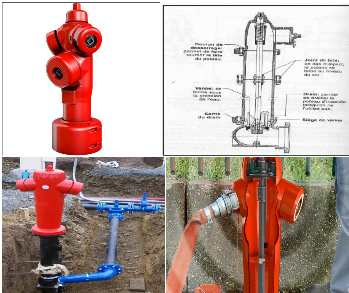
Figure VI.8 : Le poteau d'incendie [8]
