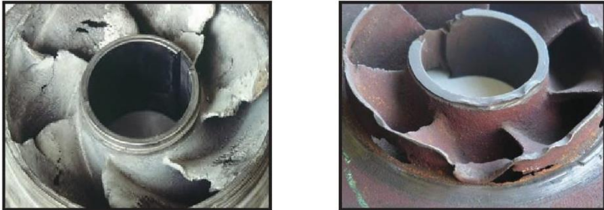
Figure V.5 Effets de la cavitation sur une roue
