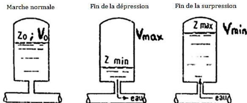
Figure VII.2 : Mode de fonctionnement d'un réservoir d'air. (BOUCHAIB.S, 2017)
