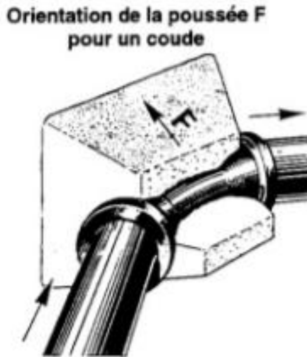
Figure V-03 : Butée sur coude
