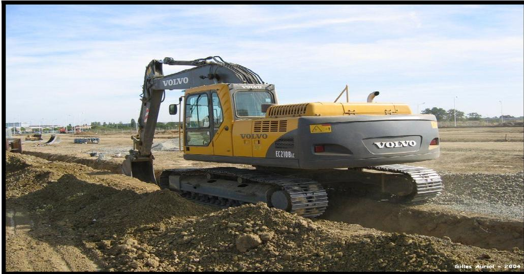
Fig VI.3.2: Pelle hydraulique
