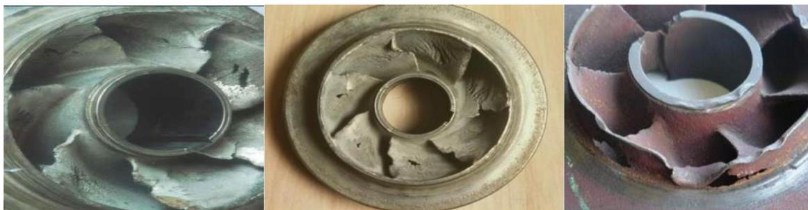
Figure IV.2 : Roues soumises à la cavitation.
