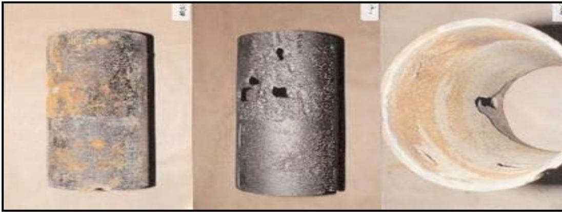
**Figure III.1: Corrosion des conduites métallique**
