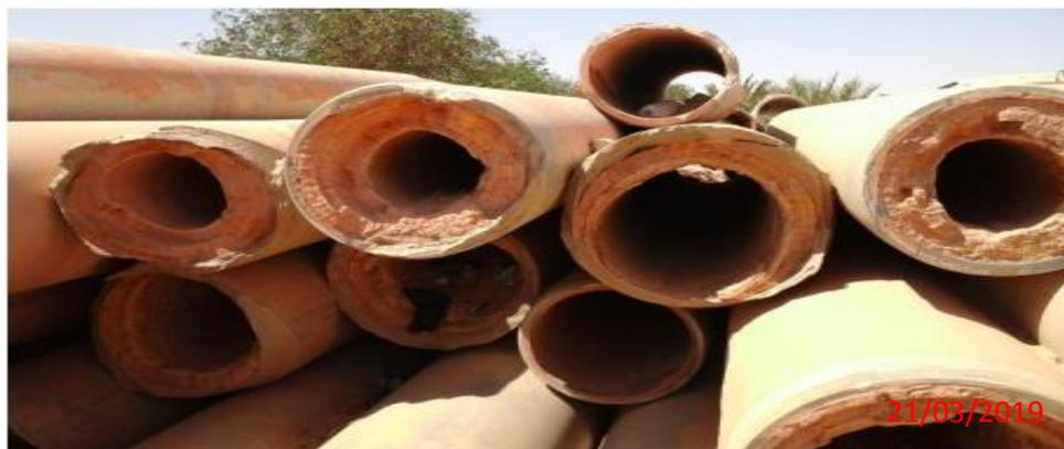
**Figure I.4 :** Conduites entartrées en dépôt au Complexe
