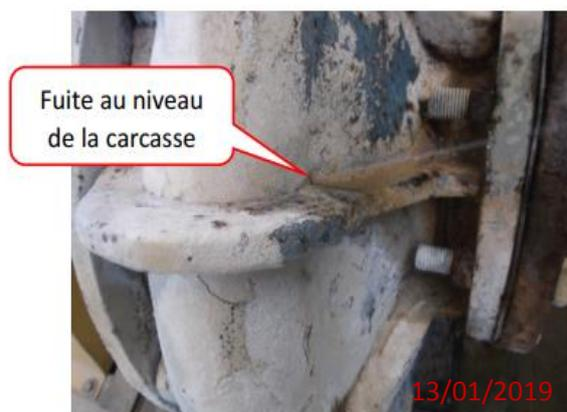
**Figure II.29 :** fuite au niveau de la carcasse
