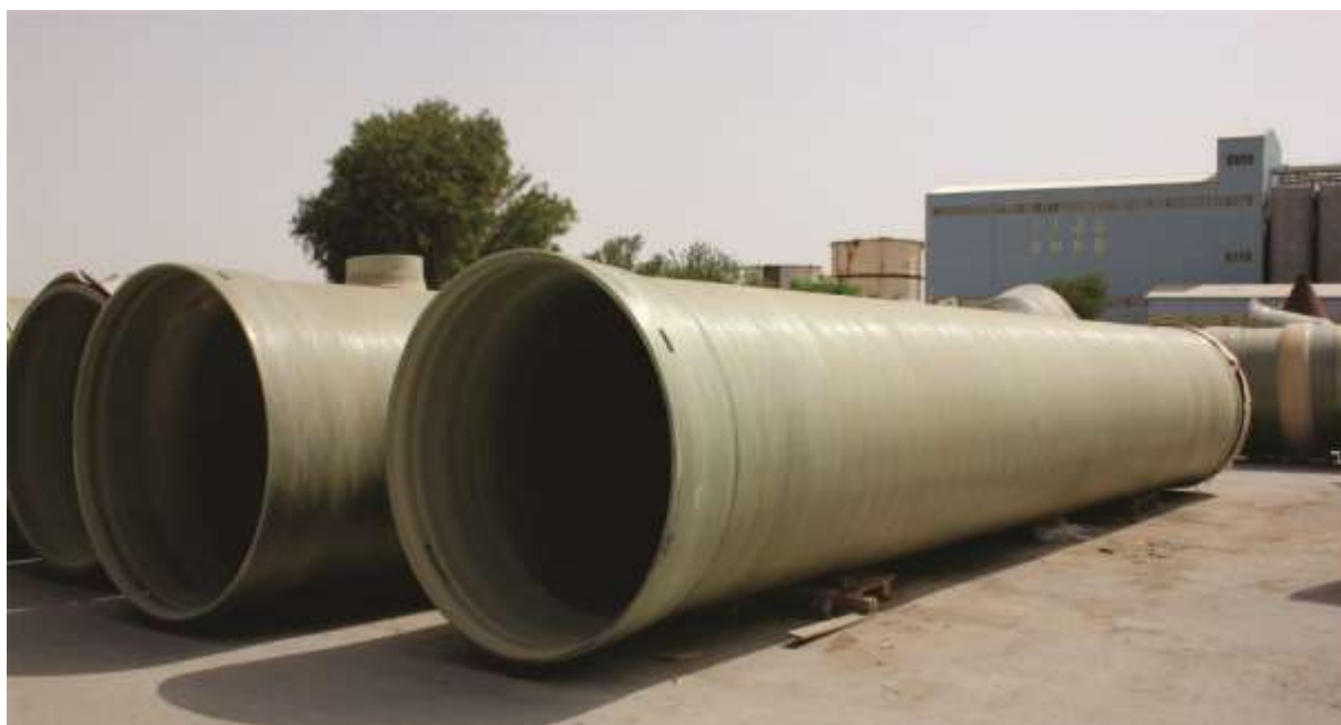
Figure III-3: Conduite en PRV.
