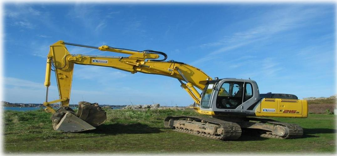
**Figure VII.3** : la pelle mécanique hydraulique.
