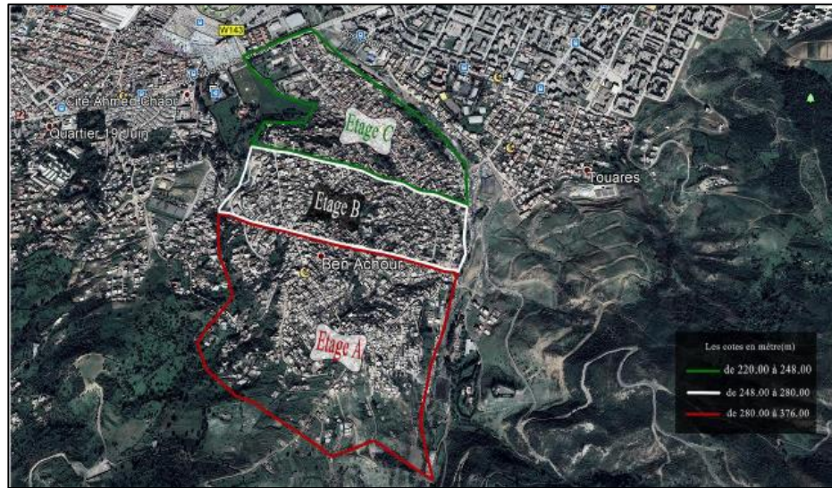
Figure (I.4) : Représentation des étages d'AEP de la cité de BEN ACHOUR [4]
