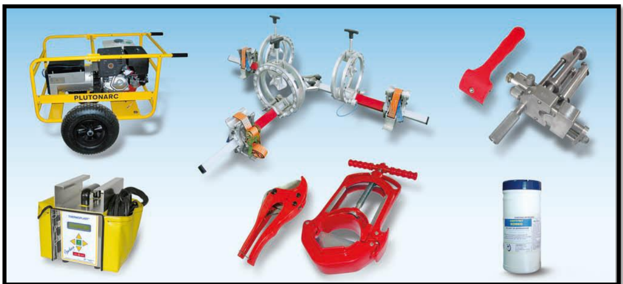
Figure VI.2: équipements de l'électro-soudage(catalogue du groupe CHIALI,2020)
