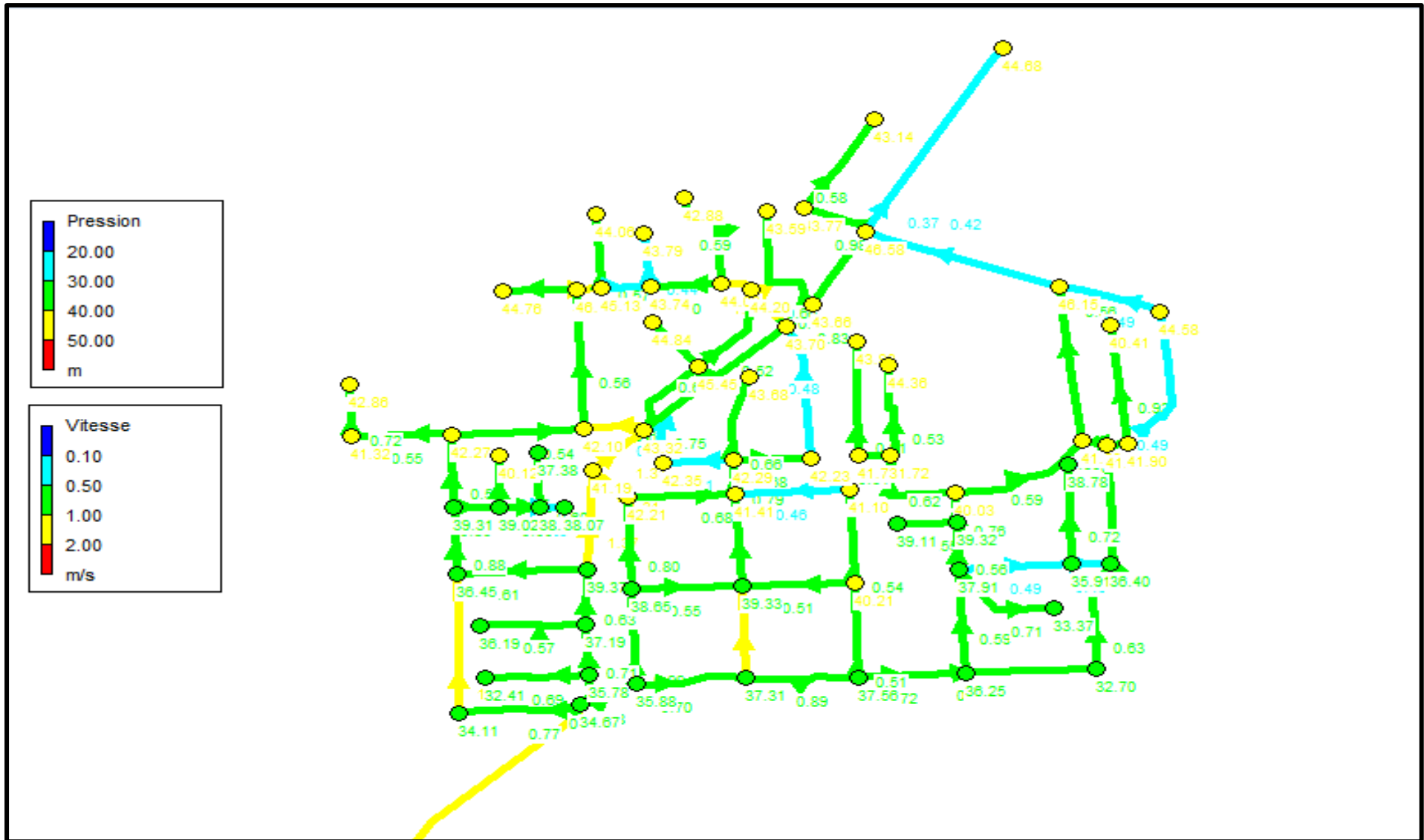
Figure V.2. Etat des pressions et des vitesses dans le cas de pointe (partie 2) pour le réseau projeté
